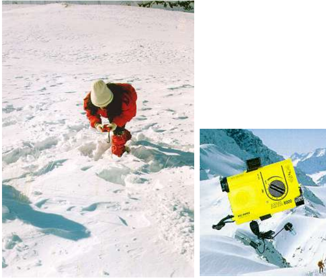
Şekil 13. Solda, elektronik alıcı ve verici ile arama uygulaması, sağda, kullanılan cihazlardan bir örnek –Erzurum (foto. AFET Çığ Grubu, 1998)
